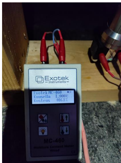
Yläasteen yläpohjan runkotavaran kosteuksia
