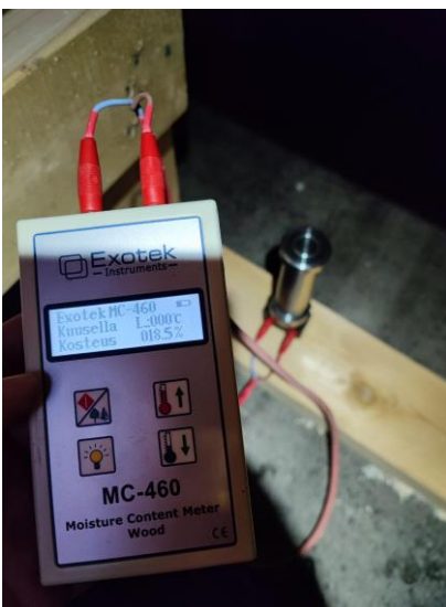
Yläasteen yläpohjan runkotavaran kosteuksia
